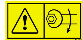
Vérifiez que l'ensemble des vis et boulons ont été serrés avant d'utiliser la machine
